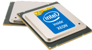
Two Intel Xeon E5-2697 v2 CPUs
