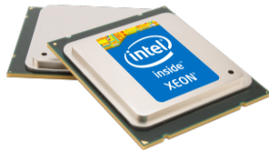
Two Intel Xeon E5-2697 v2 CPUs
